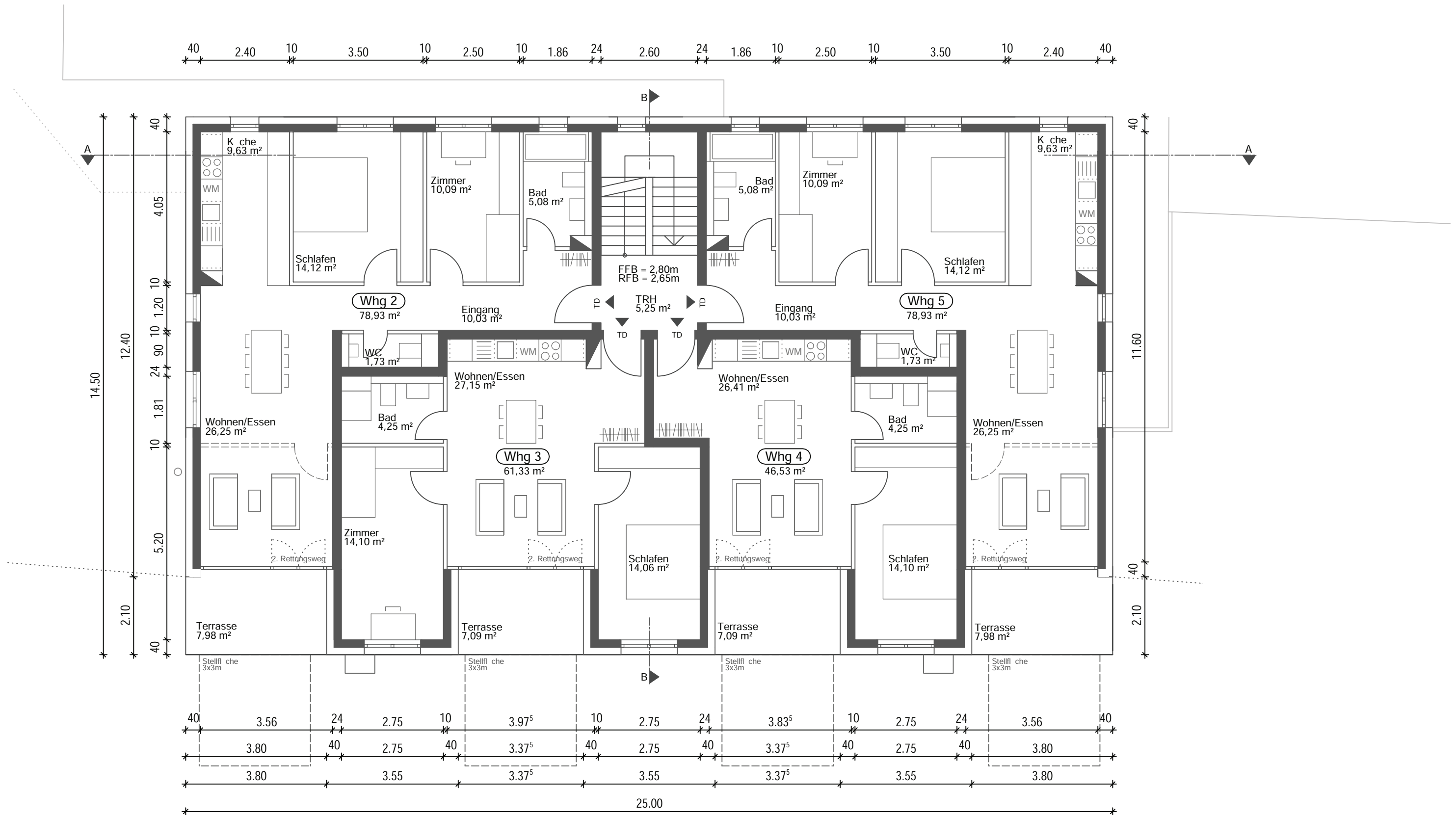
Haus 14 Grundriss Erdgeschoss M 1:100
