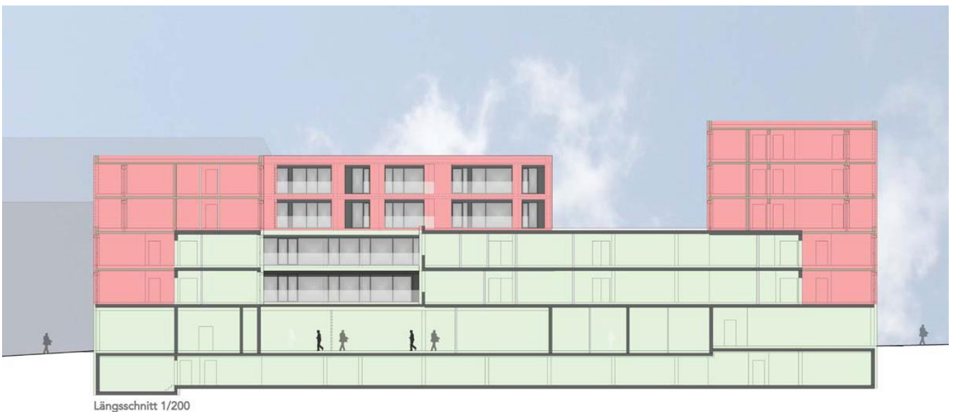
Schnitt – Holz-Hybrid-Bauweise (rot), Massivbau (grün)
