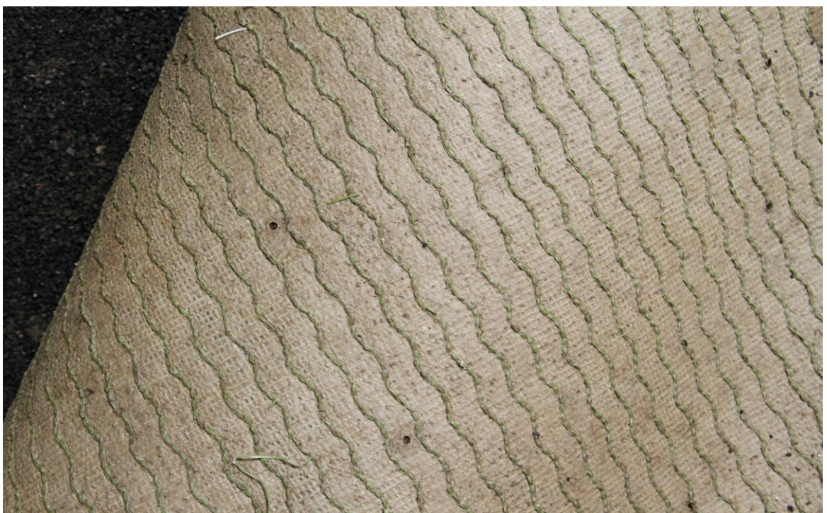
Bild 2: Übersicht zu Bild 1 ohne wirksame Einbindung der Kunstrasenfasern
