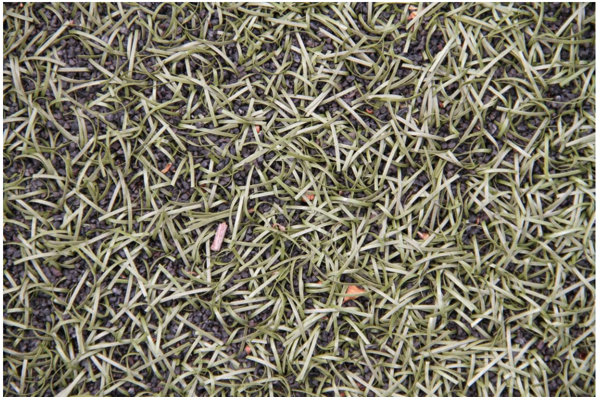
Bild 3: Keine sichtbaren Verschleißerscheinungen an den Kunstrasenfasern im wenig frequentierten Randbereich
