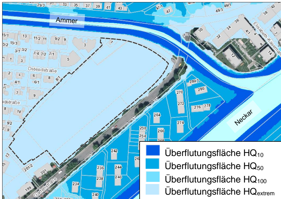
Abb. 10: Hochwassersituation im Bereich des Vorhabens
